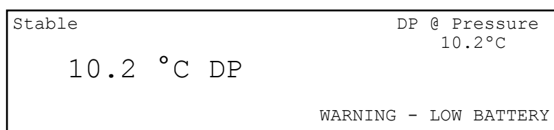
Рис. 4. Дисплей с выведенным сообщением о низком уровне зарядки аккумуляторов.
